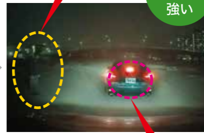
ヘッドライトに照らされていても白とびせず、ナンバープレートの認識が可能。
