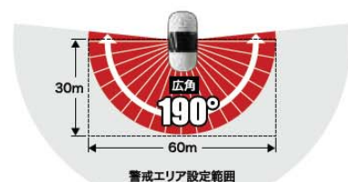
図① レーザーセンサーの検知範囲
