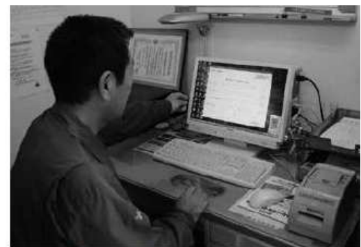
運行後、運転手が事務所のカードリーダーにSDカードを差し込むだけで、デジタコとドラレコの2つのデータを1つのソフトで管理できる。
